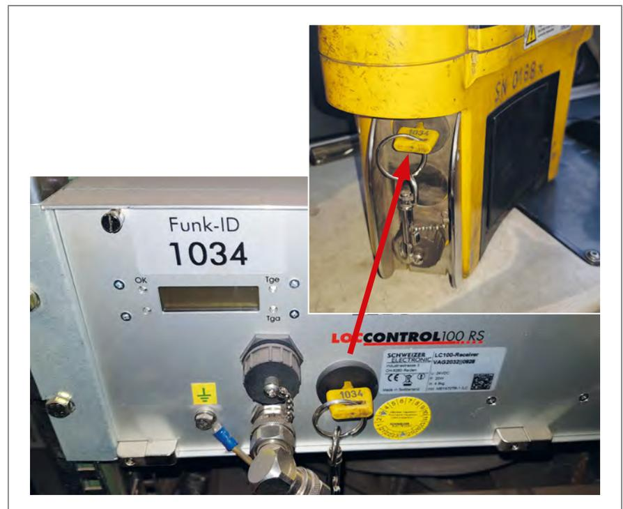
Abbildung 8: Bei diesem System werden Sender und Empfänger durch Umsetzen des Adresssteckers zugeordnet (gekennzeichnet mit „1034“). Durch die eindeutige Kennzeichnung ist auch im laufenden Betrieb die Zuordnung von Sender und Empfänger zweifelsfrei nachvollziehbar.
