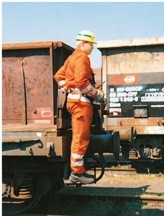
Abbildung 13: Unzureichende Steuerstände: Ungünstige Haltung, schlechte Festhaltungsmöglichkeit und kleiner Rangierertritt. Ist der Handgriff nicht seitlich des „kleinen“ Rangierertrittes angeordnet, kann sich der Lokrangierführer nur unzureichend festhalten.
