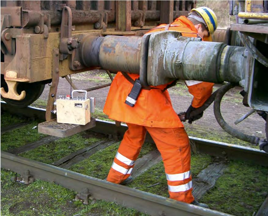
Abbildung 16: Zum Kuppeln setzt dieser Lokrangierführer den Sender auf dem Rangierertritt ab, um leichter unter dem Puffer hindurch zu schwingen. Dieses darf er nur, wenn es vom Unternehmen zugelassen ist.
