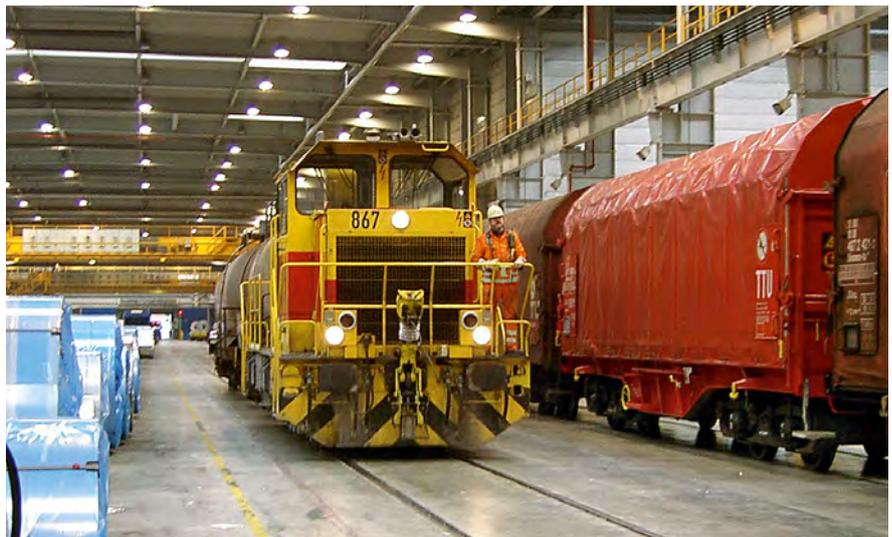
Abbildung 1: Der Lokrangierführer steuert das Triebfahrzeug von der Endbühne auf der Stirnseite aus. Von dort kann er den Gleisbereich viel besser beobachten, als wenn er vom Führerraum aus steuert.
