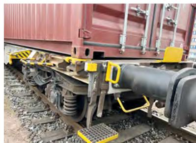
Abbildung 15: Auf Wagen, die mit nicht festlegbaren Rangiererhandgriffen ausgestattet sind, darf der Lrf nicht mitfahren.
