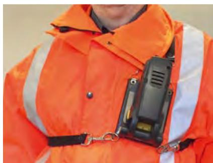
Abbildung 5: Auch GSM-R-Handsprechfunkgeräte mit integriertem Neigungssensor kommen für den willensunabhängigen Personennotruf zum Einsatz.
