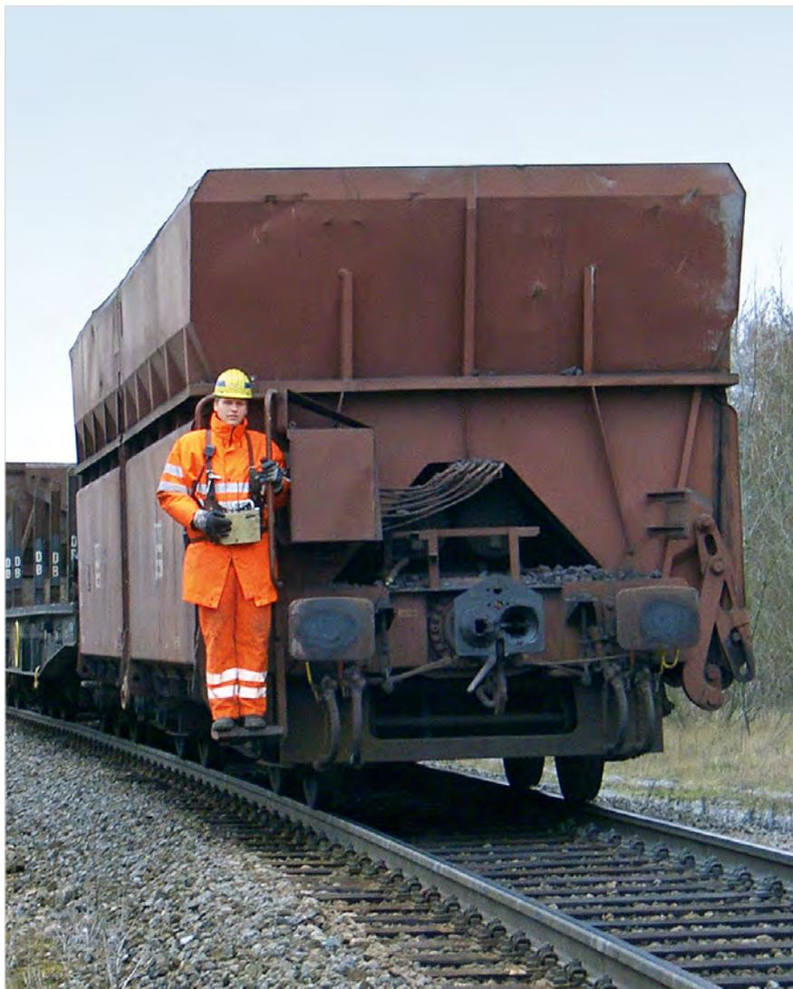
Abbildung 19: Funkferngesteuerte Zugfahrten sind nur zulässig, wenn die Sicherheitsmaßnahmen und ergonomischen Bedingungen denen bei Rangierfahrten entsprechen.
