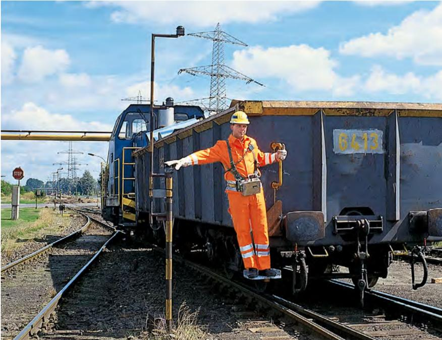
Abbildung 2: EOW und EOGS „liefern“ einen Sicherheits- und Zeitgewinn. Zum Stellen der EOW oder EOGS muss nicht mehr auf- und abgestiegen werden. Die Bedienung erfolgt über Schlagtaster.
