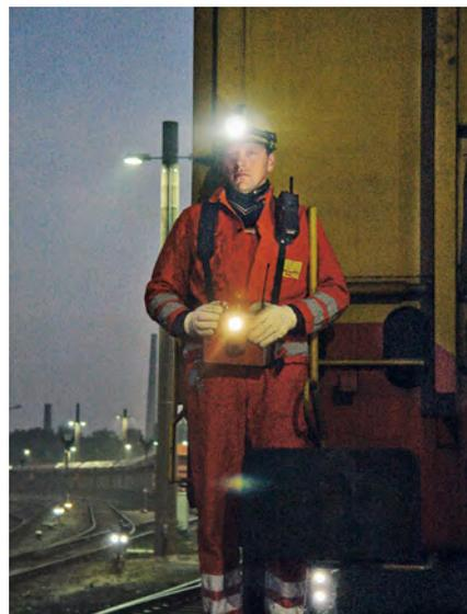
Abbildung 7: Wird neben der Rangiererhandleuchte vom Lokrangierführer zusätzlich eine Leuchte am Schutzhelm eingesetzt, ist die Rangierfahrt deutlich besser zu erkennen.
