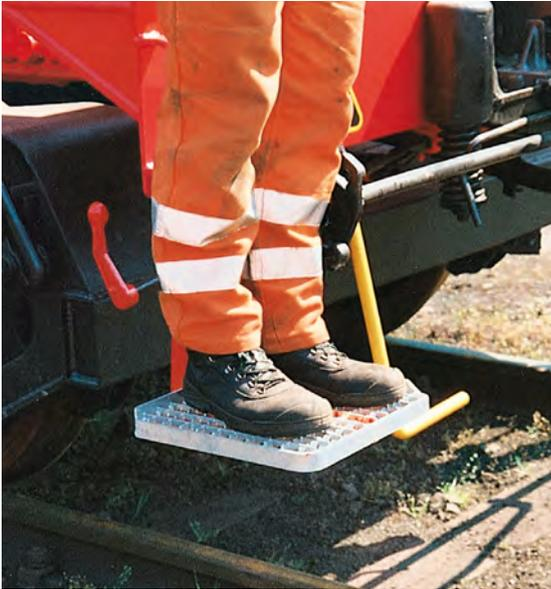
Abbildung 14: Verbesserter Rangierertritt nach DIN EN 16116-2: Große Standfläche, gute Festhaltemöglichkeit. Der Lokrangierführer hat sich im Handgriff „eingehakt“.
