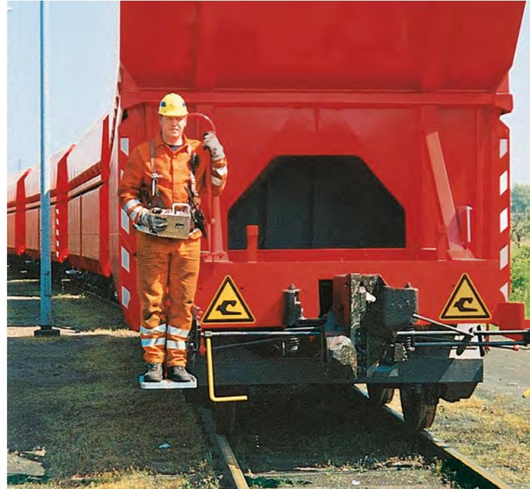
225 mm x 270 mm angebaut. Häufig kann der Lrf darauf wegen der Größe der Standfläche nicht vollflächig mit beiden Füßen aufrecht stehen. Deshalb sind diese Tritte für den Lrf aus ergonomischen Gründen grundsätzlich weniger geeignet. Allerdings besteht keine Pflicht, diese älteren Güterwagen mit größeren Tritten nachzurüsten.
