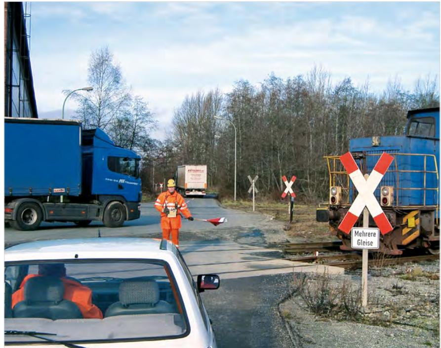
Abbildung 17: Bei der Postensicherung ist der Lokrangierführer auch durch den Straßenverkehr gefährdet.
